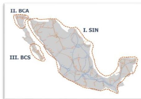
Figura 3. Zonas de Potencia del Sistema Eléctrico Nacional
